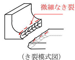
図-8 き裂断面状況
