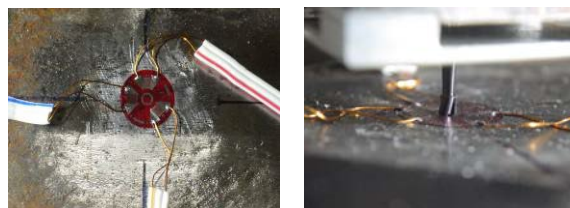
図 39 ロゼットひずみゲージと穿孔状況
