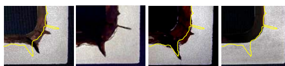
図 30 き裂状況と切断面 (F 橋)
